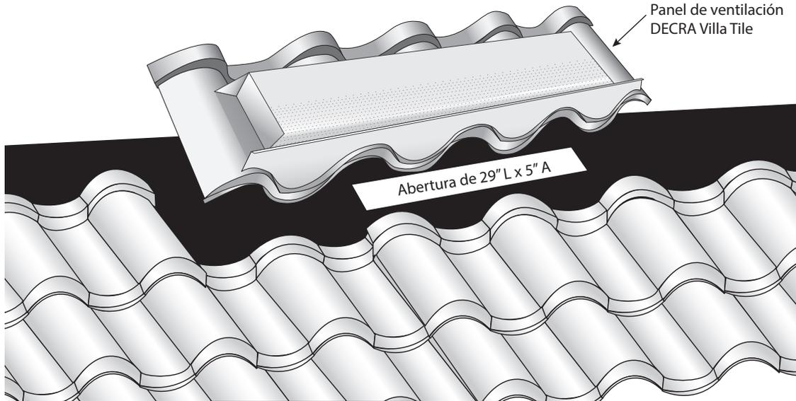
Los paneles de ventilación DECRA deben instalarse en la última hilera completa debajo de la cumbrera y a no más de 4 pies por debajo del punto máximo de la cresta del techo. Las rejillas de ventilación del panel NO deben usarse para la entrada de aire.
