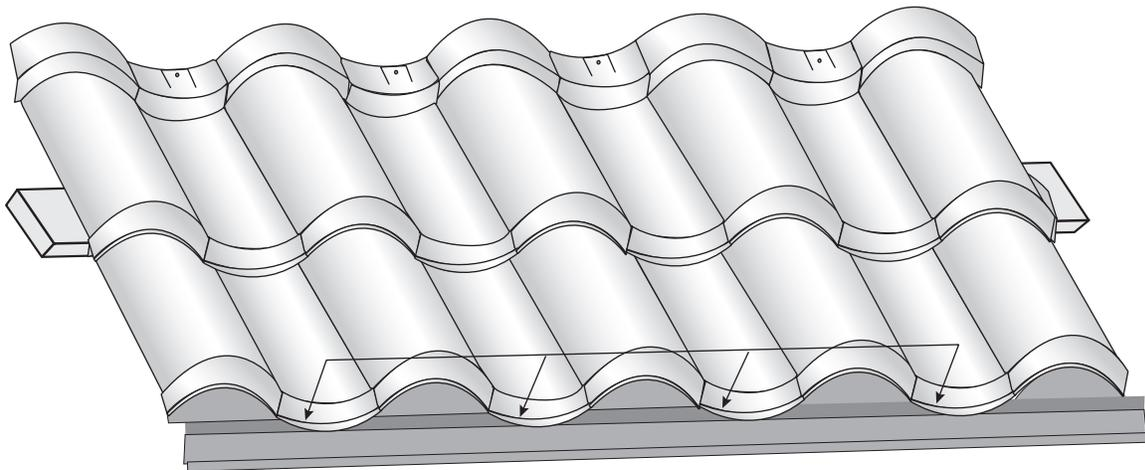
Instale los tapajuntas de cierre en alero y atorníllelos a través del borde frontal del panel, a un lado del punto bajo del panel.
