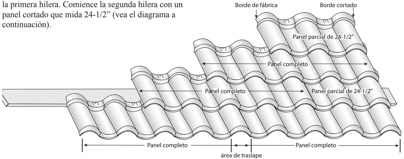
Mida los paneles y haga los cortes correspondientes para que el borde cortado comience (o termine) en el canal DECRA o limahoya Villa (vea el diagrama a continuación). Los paneles se pueden cortar desde cualquier lado (vea el diagrama a la derecha). Guarde las piezas cortadas para usar en el lado opuesto que termina en una limahoya Villa o un canal DECRA
