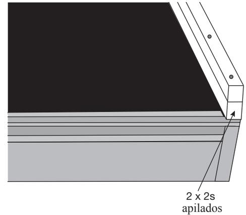
Pinte previamente la parte vertical/expuesta del canal DECRA según sea necesario antes de instalar los paneles.
