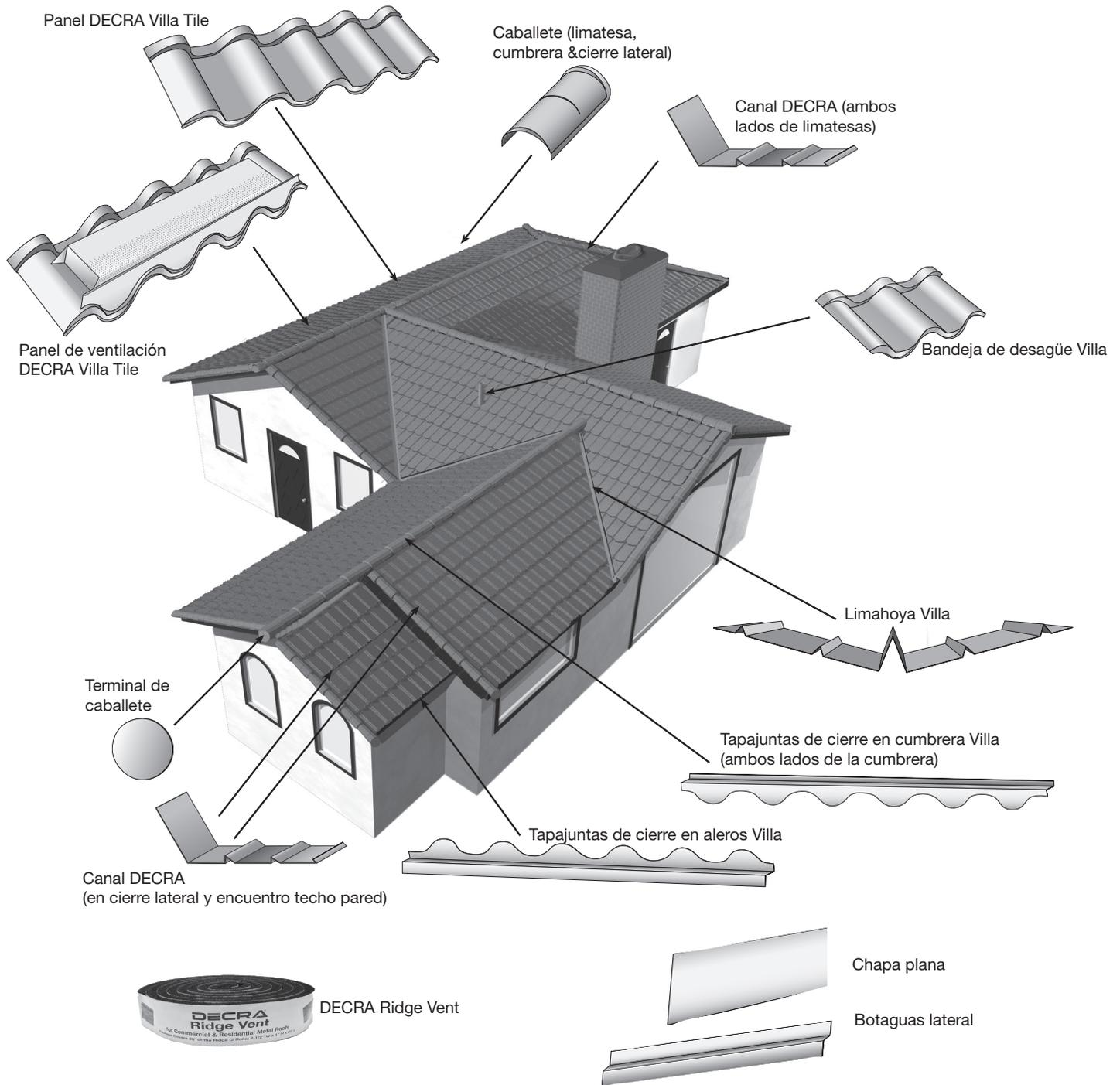
***Se utilizan listones de madera 2x2 apilados en limatesas, cumbresas y en cierres laterales para sujetar los accesorios. Es posible que se requiera una fila adicional dependiendo de la pendiente del techo***
