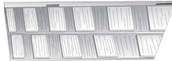
Corte el lado derecho de la teja para que encaje a la limahoya, limatesa o borde lateral del techo.
